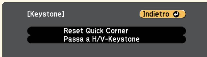
L'impostazione **Keystone** è ora impostata su **Quick Corner** nel menu **Impostazioni** del proiettore. La volta successiva in cui si premono i tasti di regolazione del keystone sul pannello di controllo, verrà visualizzata la schermata di selezione dell'area.
